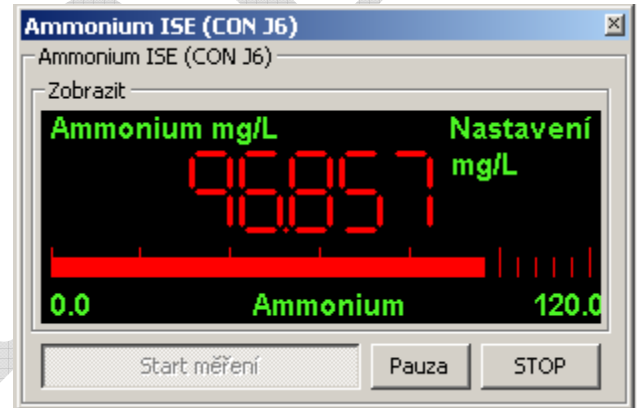
Obrázek 40 Nastavení měření - plovoucí panel s okamžitou hodnotou měření
